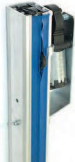
In den stabilen Holmen aus einer besonderen Aluminiumlegierung laufen speziell entwickelte Gleiter, an denen das Netz fixiert ist. Diese sorgen dafür, dass die Ladung jederzeit gut gesichert ist. In der Stadt und auch im Überlandverkehr.
