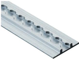
Die Bodenschiene wird vorzugsweise durch Verklebung und Verschraubung auf der Fahrzeugkarosserie befestigt. Die auftretende Belastung wird dadurch gleichmäßig in die feste Fahrzeugstruktur eingeleitet. Um ein optimales Verhältnis von Gangbreite zu Regaltiefe zu erreichen, benötigt TransSAFE<sup>®</sup>rack ein Spurmaß der Schienen von 615 mm.
