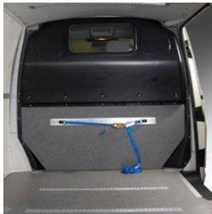
Nutzen Sie die Vorteile einer planen Laderaumtrennwand. Neben dem Schutz der Trennwandfläche des Fahrzeuges haben Sie optional die Möglichkeit Zurrschienen anzubringen. Damit können Sie stehende Teile fixieren. Behältnisse kippen nicht mehr um, Material gerät beim Bremsen nicht mehr unkontrolliert in Bewegung.
